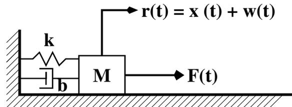
Fig. 1. Spring/Mass “Slinky”
